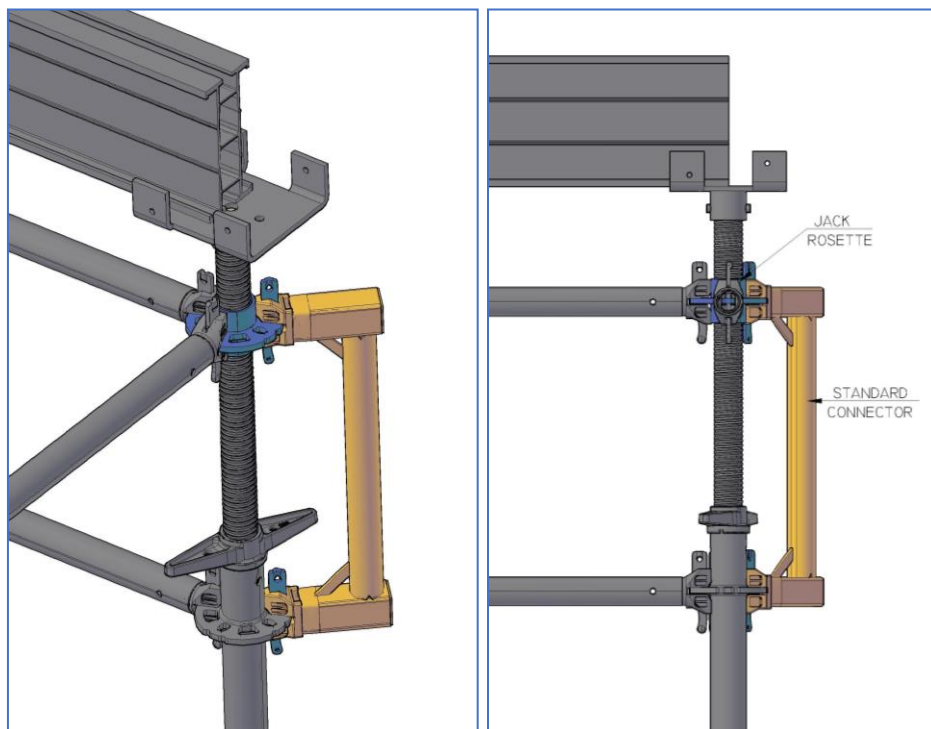
Picture 4.5.2 圆饼座应用于顶部丝杆超高.
