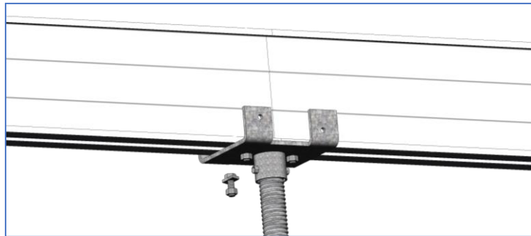
Picture 3.11.1: 铝梁和天托的连接固定
